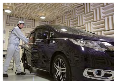
ドア閉音を無響室で確かめる、心理音響技術を用いた解析実験（三井金属アクト）
